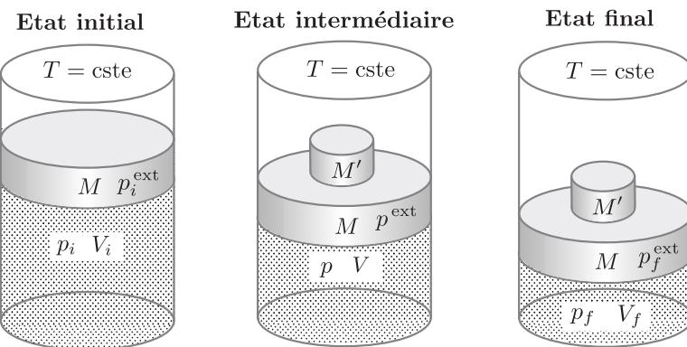
On modélise la compression isotherme d'un système thermodynamique fermé constitué de  $N$  moles de gaz parfait enfermé dans un cylindre vertical par un piston de masse  $M$  et d'aire  $A$ . Le cylindre est placé dans une enceinte dans laquelle on a fait le vide. Il n'y a donc pas de pression atmosphérique à considérer dans ce problème. De plus, le système est maintenu à température constante  $T$  par contact avec un réservoir de chaleur.
